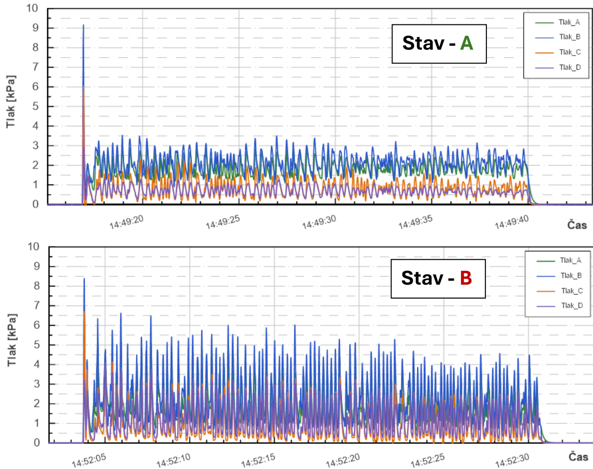
Obr. 8 Záznam změny tlakového pole ve fluidní vrstvě při změně průtoků mezi jednotlivými skupinami distribučních trysek
